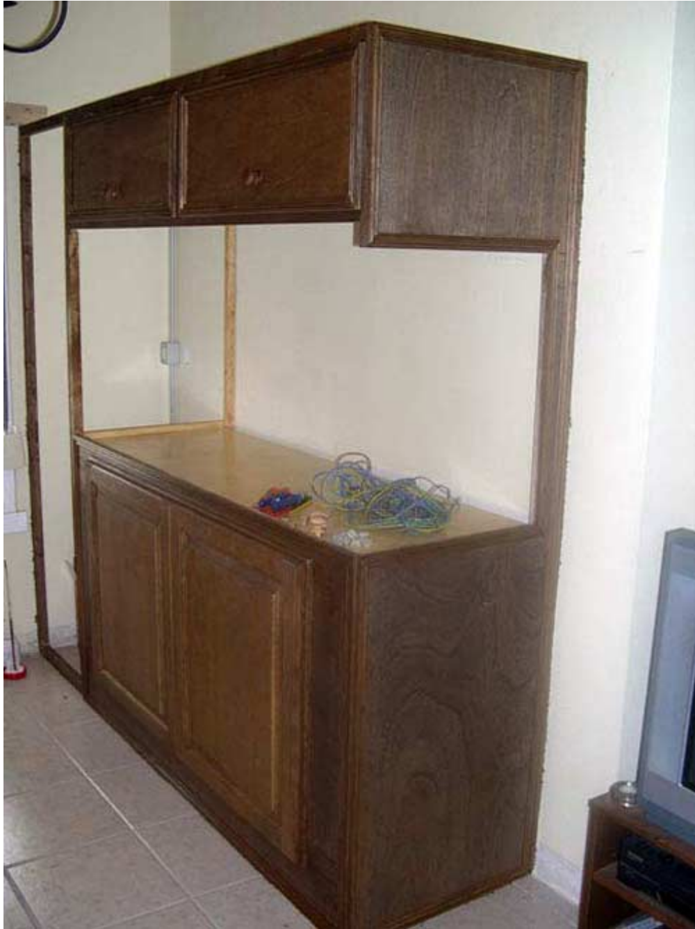
Aspecto exterior del mueble tras la operación de tintado.
